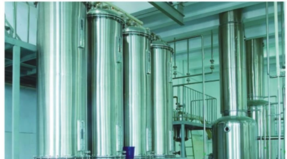
高纯度大豆低聚肽水解液离子交换、去除无机灰分工段
